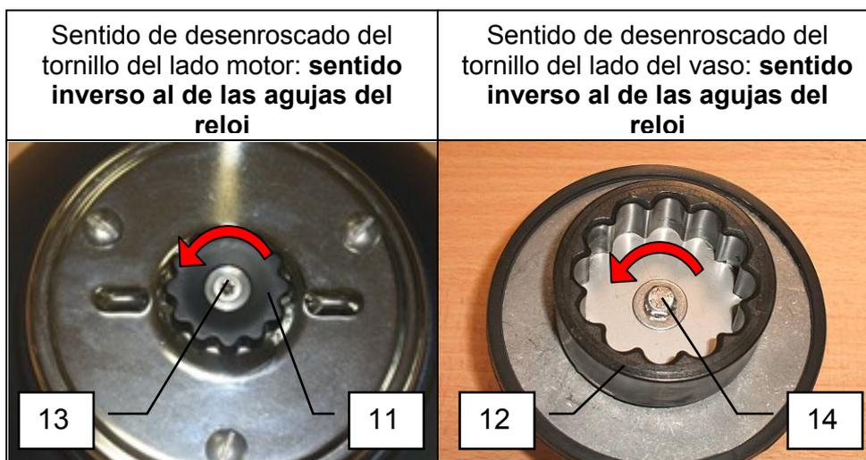
**NOTAS:** Para las versiones del N°37 anteriores a 2012, hay que girar el tornillo (13) en el **sentido de las agujas del reloj** para soltar el acoplamiento flexible (11).
